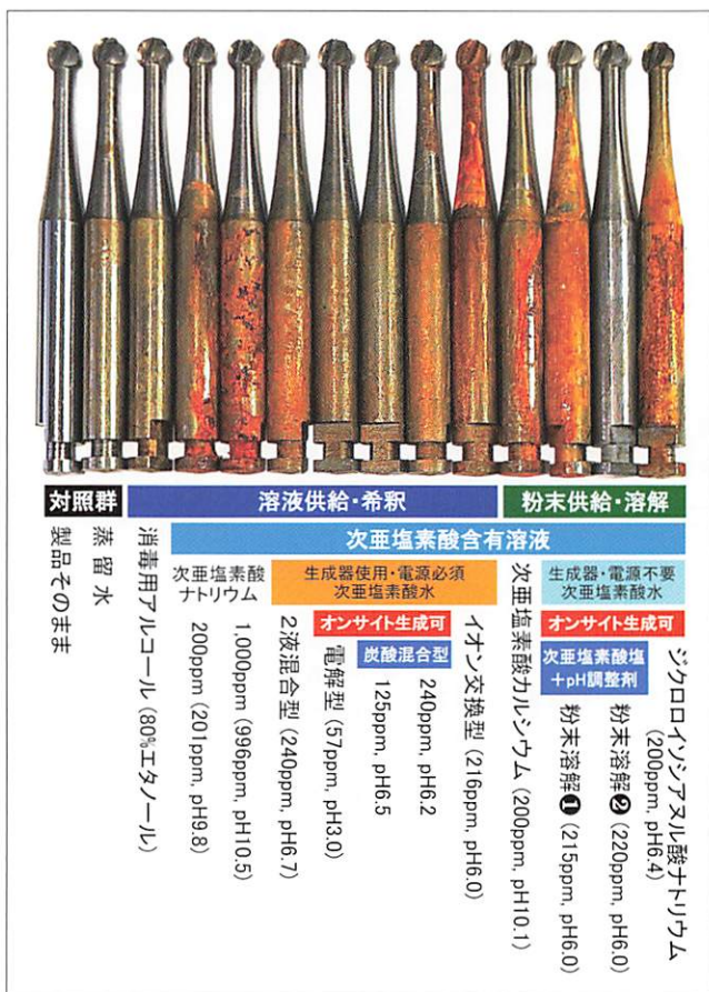
図4 歯科用切削スチールバー (炭素鋼製) の錆発生テスト 歯科用切削スチールバー (ELA スチールバー CA 6, 松風) に対して、各溶液中に15分浸漬→蒸留水で水洗→30分自然乾燥を10回繰り返した (合計浸漬時間: 2時間30分)。
