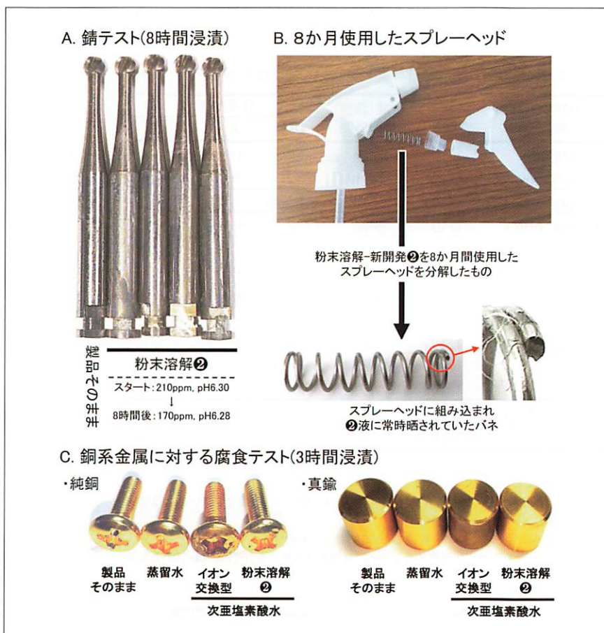
図5 粉末溶解②を用いた錆・腐食発生テストと実際
